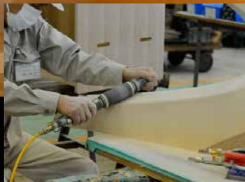
◆接合した脚部をヤスリをかけ、美しい曲面に仕上げている
