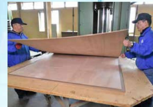
◆天板の製造工程は製品により20から30ほどある。写真は多層構造による天板材料の組み合わせ工程。この後、板を張り合わせる接着・プレス工程に回される
