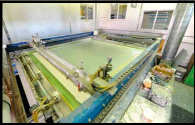
▲表面の白線を印刷する工程。ここでようやく卓球台の天板らしさが見えてくる
