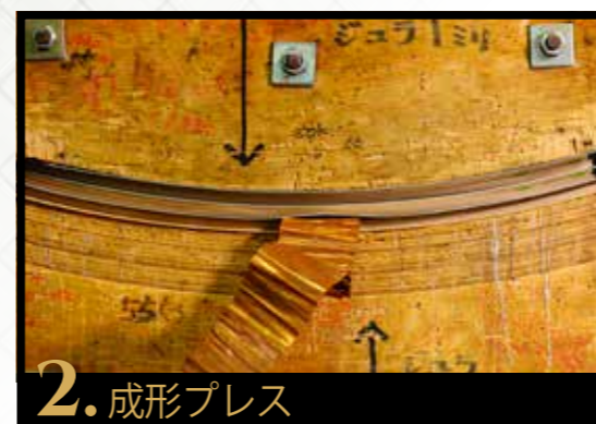
▲天童木工が誇る成形合板。単板を貼り合わせ、同時に熱を加えながらプレスして、成形合板を製作していく
