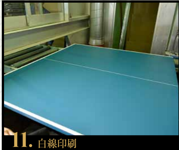
▲表面の白線を印刷する工程。ここでようやく卓球台の天板らしさが見えてくる
