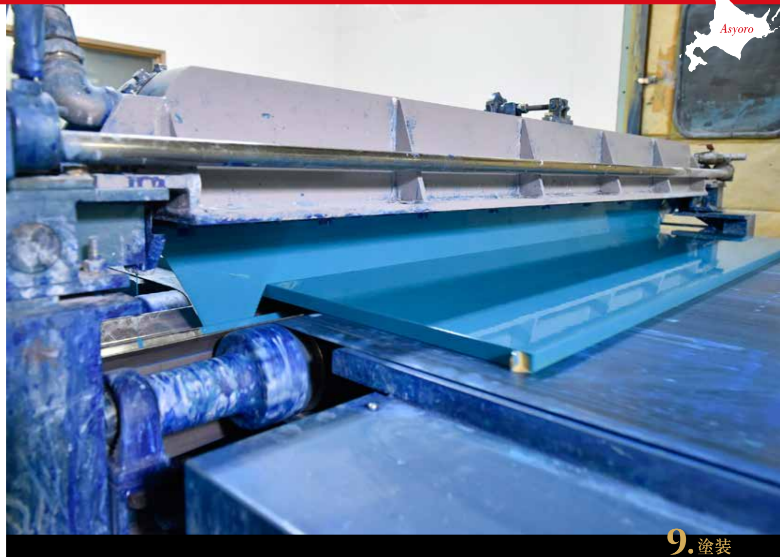
▲調整終わった天板にフローコーターと言われる特殊な塗装装置で色を重ねていく
