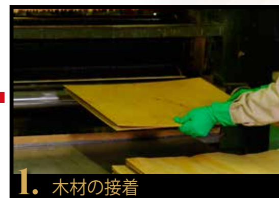
▲東日本大震災の被災地である岩手県宮古市腹帯のブナ材を使っている。まず薄い板を接着剤の間を通して合板を作っていく
