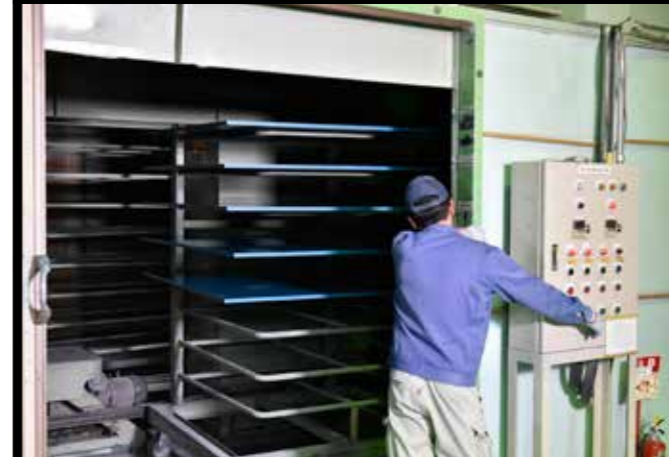
◀塗装を終えた天板は大きな乾燥炉で乾燥工程に回される
