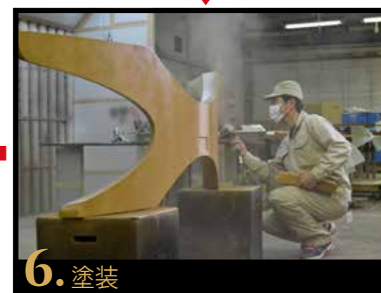
▲組み立てられた脚部を塗装する。木目を殺さずに仕上げる。脚部の場所によって陰影をつけ微妙に色を変えている
