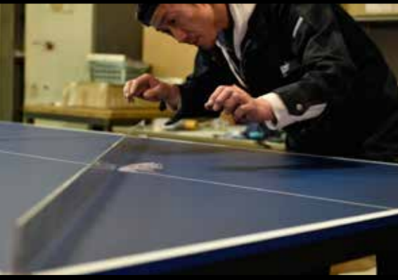
◀▲最終の検査工程では、様々なパーツによって組み合わされた卓球台の、高さや、天板のそりなど、競技ルール・安全装置の確認などのチェックが行われていく
