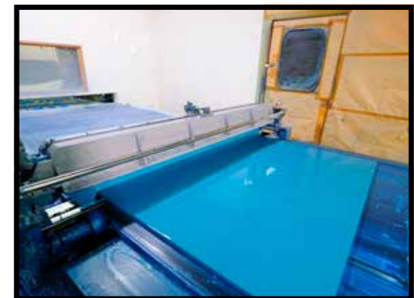
▲滝のように流れる塗料の下を、天板が高速に通過することによって、厚く均一な塗装面が仕上がっていく
