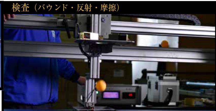
▶厳しく定められているバウンド、反射、摩擦などは自社開発した装置によってチェックされていく
