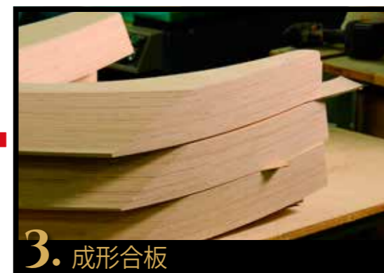
▲脚の部分は3つの大きな塊が元になっている。およそ58枚の板を接着した木の塊ができる
