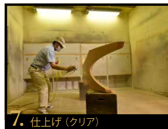
▲組み立てられた脚部を塗装する。木目を殺さずに仕上げる。脚部の場所によって陰影をつけ微妙に色を変えている
